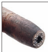
Bocal totalmente entupido (sem proteção E-Weld Nozzle)
