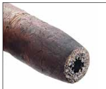
Bocal totalmente entupido (sem proteção E-Weld Nozzle)
